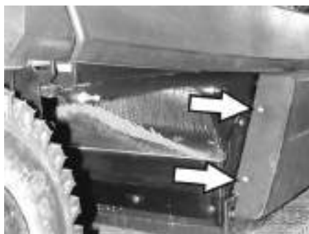
Tömlőcsatlakozás a vákuumszivattyúhoz és a vákuumszelencéhez (tároló)
