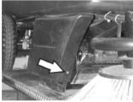
Süpürme merdanesi indirme mekanizmasının vakum tüpüne giden hortum bağlantıları
