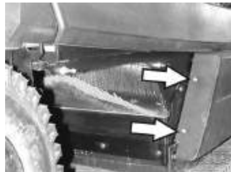
Conexiones de manguera para bomba de baja presión y para diafragma controlado por vacío (depósito)
