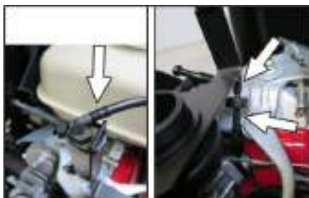
Slangetilkobling for undertrykkspumpe og til undertrykkslange (akkumulator)
