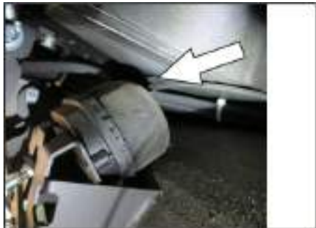
Hadicová přípojka k podtlakové nádobě pro snižování bočního smetáku
