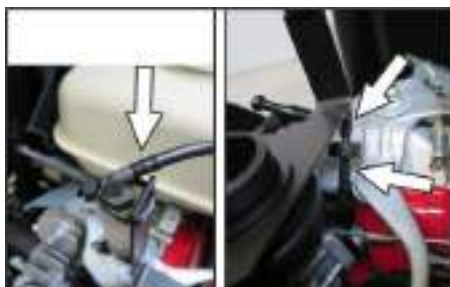
Slūteņu pieslēgumi vakuumsūkņim un vakuuma kārbai (uzkrājējs)
