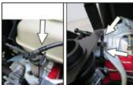
Tömlőcsatlakozás a vákuumszivattyúhoz és a vákuumszelencéhez (tároló)
