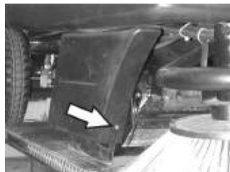
Raccordi dei tubi flessibili della camera di sottopressione del dispositivo di abbassamento del rullo spazzola
