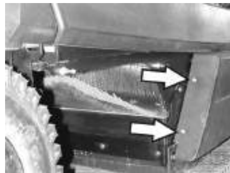
Raccordi dei tubi flessibili della pompa a sottopressione e della camera di sottopressione (accumulatore)
