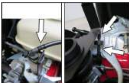
Slangaansluitingen naar de onderdrukdoos voor het omlaag brengen van de veegrol
