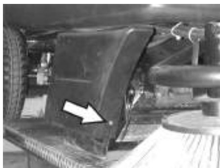
Slūteņu pieslēgumi slaucītājveltna nolaišanas mehānisma vakuuma kārbai
