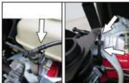
Raccordi dei tubi flessibili della pompa a sottopressione e della camera di sottopressione (accumulatore)
