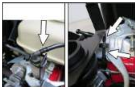
Элемент подключения шланга для мембранного механизма вакуумного регулятора подметающего вала.
