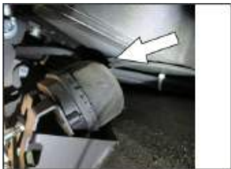
Conexión de manguera para diafragma controlado por vacío del dispositivo de descenso de escoba lateral
