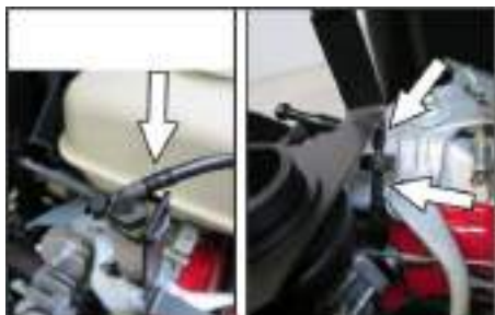
Slangetilslutningerne til undertrykspumpen og undertryksdåsen (lager)
