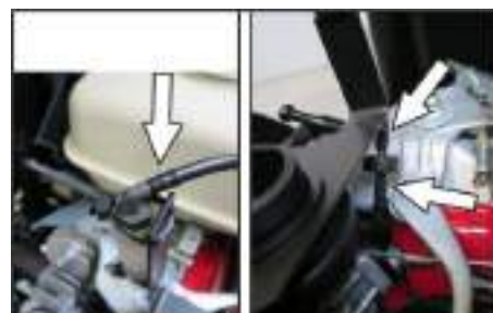
Schlauchanschlüsse zur Unterdruckpumpe und zur Unterdruckdose (Speicher)
