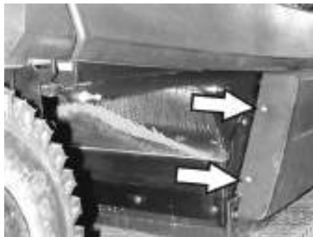
Hadicové prípojky k podtlakovému čerpadlu a podtlakovej nádobe (pamäť)
