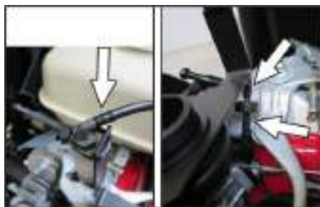
Conexiones de manguera para bomba de baja presión y para diafragma controlado por vacío (depósito)
