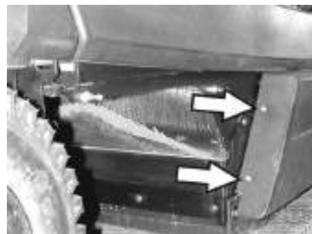
Conexões de tubulação flexível para a bomba de pressão negativa e para a caixa de pressão negativa (acumulador)
