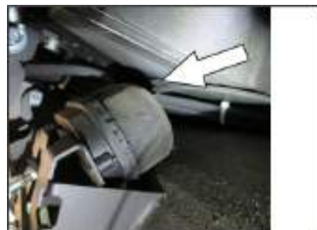
Schlauchanschluss zur Unterdruckdose der Seitenbesenabsenkung
