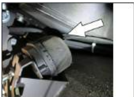
Conexão de mangueira para a caixa de pressão negativa de descer a escova lateral
