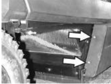
Vakum pompasına ve vakum tüpüne (hazne) giden hortum bağlantıları
